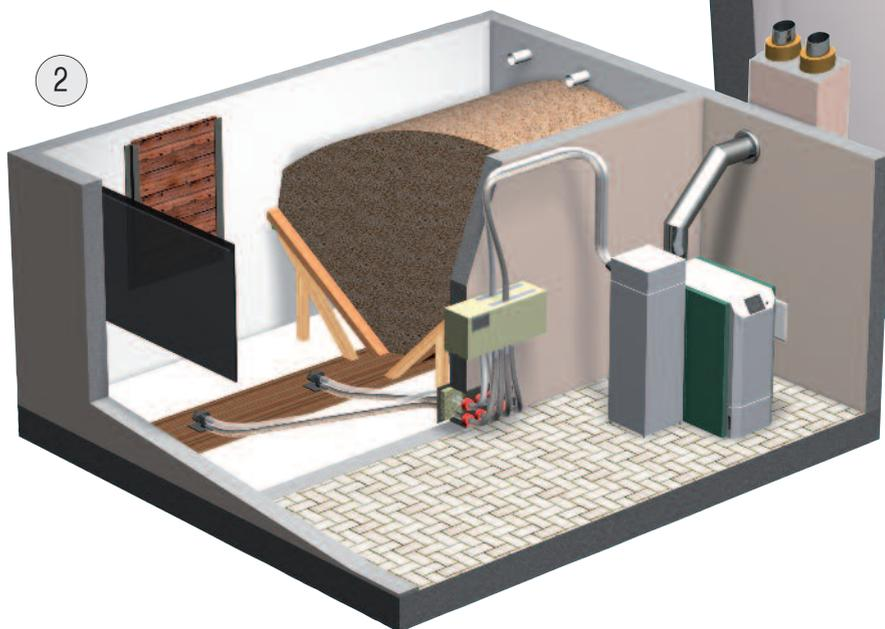
... Благодаря шнеково-пневматической подаче топлива
