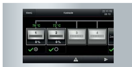
Vitotigno 300-C – Grundanzeige der Kaskade für bis zu vier Holzheizkessel mit Kesselinformationen
