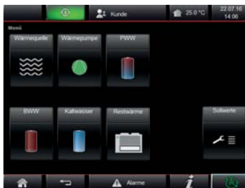
Einfach zu bedienende SPS-Regelung mit Farb-Touch-Display
