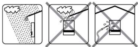
Figura 2.1 Evitare un contatto continuo con acqua
