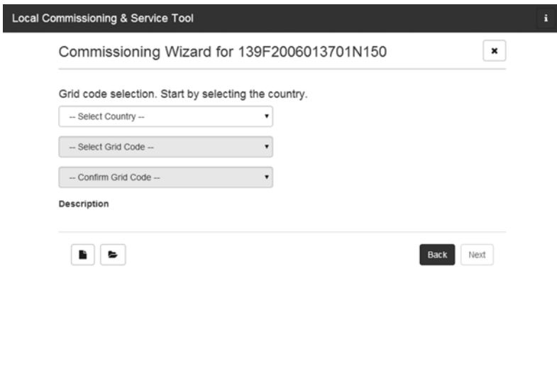
Figure 12: LCS-Tool - Sélection du pays et du code réseau
