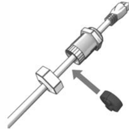
Abbildung 2.22 Kabelführung durch Kabelverschraubungen
