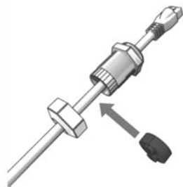
Figure 2.22 : Acheminer les câbles dans les presse-étoupes
