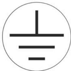
Figura 2.19 Simbolo del conduttore di protezione
