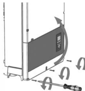
Figura 2.15 Allentamento delle viti anteriori e sollevamento del coperchio
